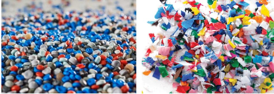
Abbildung 6: Funktionelle Einheit: 1 kg Polypropylen, Pellets (links) und Flakes (rechts) (InnoPlastics AG, n.d.; Santini, 2020)
